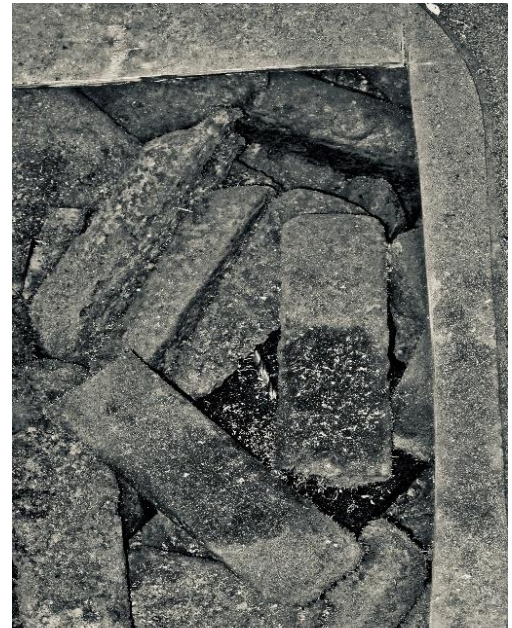
Used Hull Zincs in the Void
